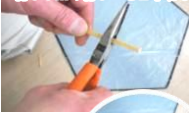
④ラジオペンチの根本の刃で、約3cmの竹ひごを2本切る
