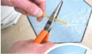
④ ラジオペンチの根本の刃で、約3 cmの竹ひごを2本切る
